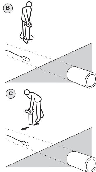
Faites de nouveau progresser la sonde de trois ou quatre pas le long du tuyau d'évacuation ou de la canalisation et localisez et marquez. Répétez la procédure tout le long de la route, aux mêmes intervalles. Il ne doit être nécessaire de modifier la sensibilité du récepteur pendant le traçage de la Sonde, que si la profondeur du tuyau d'évacuation ou de la canalisation, ou la distance entre le récepteur et la Sonde change.
