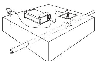
Fissare il cavo di massa a un punto di massa indipendente ad alcuni passi di distanza e preferibilmente ad angolo retto rispetto al probabile percorso della linea target. Non collegare a massa a tubi dell'acqua o linee interrate che potrebbero trasportare il segnale.
