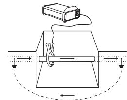
**ATTENTION!** Pour éviter le risque de choc électrique, le module de fixation du signal doit être raccordé à l'émetteur avant d'être placé autour de la canalisation ou du câble.
