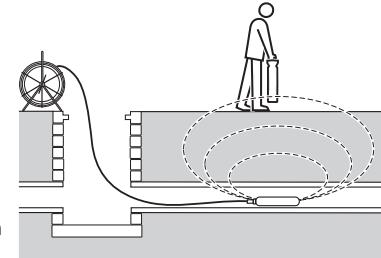
Verbinden Sie die Sonde mit der Schubstange und führen Sie es in den Abfluss oder Kanal ein, den Sie orten möchten. Behalten Sie die Sonde im Auge. Halten Sie den Empfänger vertikal direkt über der Sonde, während sich das Schwert des Empfängers in einer Linie mit der Sonde befindet.
