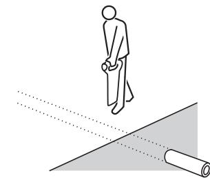
De precieze locatie van de geleider is gevonden wanneer de meteruitslag en het volume van de luidspreker het hoogst zijn.
