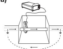
**ADVERTENCIA:** Para impedir el riesgo de electrocución, la abrazadera de señales ha de conectarse al transmisor antes de colocarse en el conductor o cable.
