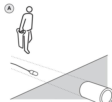
**A** déplacez les récepteurs vers l'avant et l'arrière, en alignant la lame sur la sonde et arrêtez lorsque le graphique à barres indique un pic évident.
