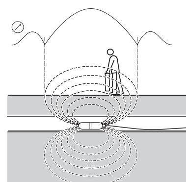
Stel de gevoeligheid van de ontvanger in op de gewenste stand, verplaats de sonde drie of vier passen naar voren en stop dan. Plaats de ontvanger boven de vermoede positie van de sonde en...
