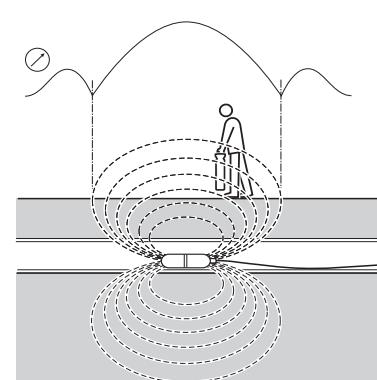
Il est important de localiser les signaux fantômes car les détecter confirme clairement la position du pic principal. Perdre les signaux fantômes réduit un peu la sensibilité du récepteur, ne permettant plus de détecter que le signal du pic principal.
