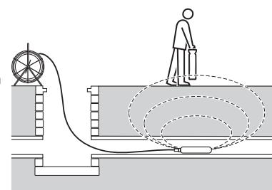
Regolare la sensibilità del ricevitore per ottenere sul grafico a barra una lettura tra 60 e 80%. Una sonda irradia un campo di picco dal centro del suo asse con segnali fantasma a ciascun lato del picco. Spostare il ricevitore leggermente su un lato e quindi lungo l'asse della sonda, avanti e indietro per rilevare i segnali fantasma.
