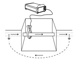
**ATTENZIONE:** Per evitare il rischio di scosse elettriche, il morsetto di segnale deve essere collegato al trasmettitore prima di essere posizionato attorno al tubo o al cavo.
