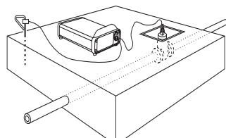
Clippez le câble de mise à la terre à un point de mise à la terre indépendant, situé à quelques pas, et de préférence à angles droits par rapport à la route probable de la ligne cible. Ne reliez pas le sol à une canalisation d'eau ou une ligne enterrée qui pourrait transporter le signal.
