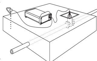
Klem de grondkabel vast aan een zelfstandig aardpunt enkele passen verderop, bij voorkeur haaks op het vermoede traject van de doellijn. Verbind de aarde niet aan een waterpijp of een ondergrondse lijn die het signaal mogelijk kan geleiden.
