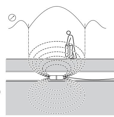
Eine Sonde strahlt ein Spitzenfeld vom Zentrum seiner Achse aus, die auch Geistersignale an jeder Seite des Spitzenfeldes enthalten. Entfernen Sie den Empfänger ein wenig zu einer Seite und dann vorwärts und rückwärts entlang der Sondenachse, um ein Geistersignal zu orten.
