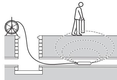
Een sonde straalt een piekveld uit vanuit het middelpunt van zijn as, met echosignalen aan weerszijden van de piek. Verplaats de ontvanger iets naar een kant en dan over de as van de sonde naar voren en naar achteren om de echosignalen te detecteren.
