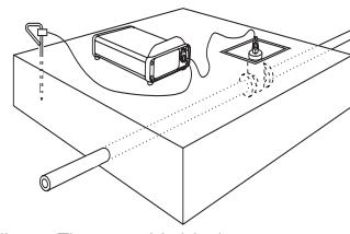
Verbinden Sie das Erdungskabel ein paar Schritte entfernt mit einem unabhängigen Erdungspunkt und vorzugsweise in einem rechten Winkel zum vermuteten Verlauf der zu ortenden Leitung. Verbinden Sie die Erdung nicht mit einer Wasserleitung oder einer erdverlegten Leitung, die das Signal übertragen könnte.
