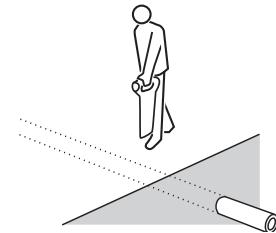
Maintenez la lame du RD2000 verticale et déplacez-vous lentement vers l'arrière et vers l'avant au-dessus de la canalisation, en réduisant la sensibilité afin d'obtenir une réponse plus affinée. Avec le RD2000, utilisez la déflexion du compteur pour faciliter la localisation. Une déflexion maximale du compteur avec un volume audible du haut-parleur indiqueront la position de la canalisation.
