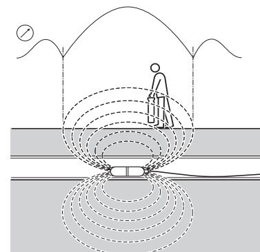
Es conveniente localizar las señales fantasma, ya que al encontrarlas se puede confirmar la posición del máximo principal. Para perder las señales fantasma, reduzca ligeramente la sensibilidad del receptor, dejando solamente la señal del máximo principal detectable.
