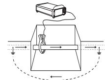
**ACHTUNG!** Um das Risiko eines elektrischen Schocks zu vermeiden, muss die Sendezange zuerst mit dem Sender verbunden werden, bevor sie um ein Rohr oder ein Kabel gelegt wird.
